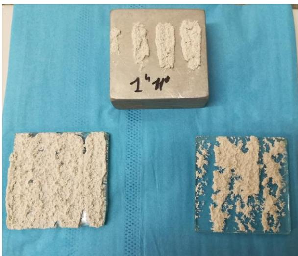
Azione del **Pentamix APL 14** sulle resistenze alla trazione in un adesivo cementizio formulato con la nostra cellulosa modificata **Penta EC 4119**
